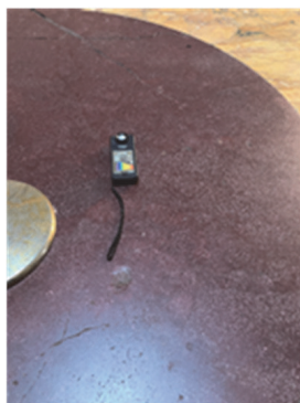
図8 分光照度系による計測の様子
