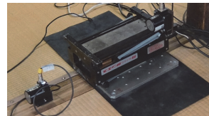
起振機を用いた 連棟京町家の振動計測
