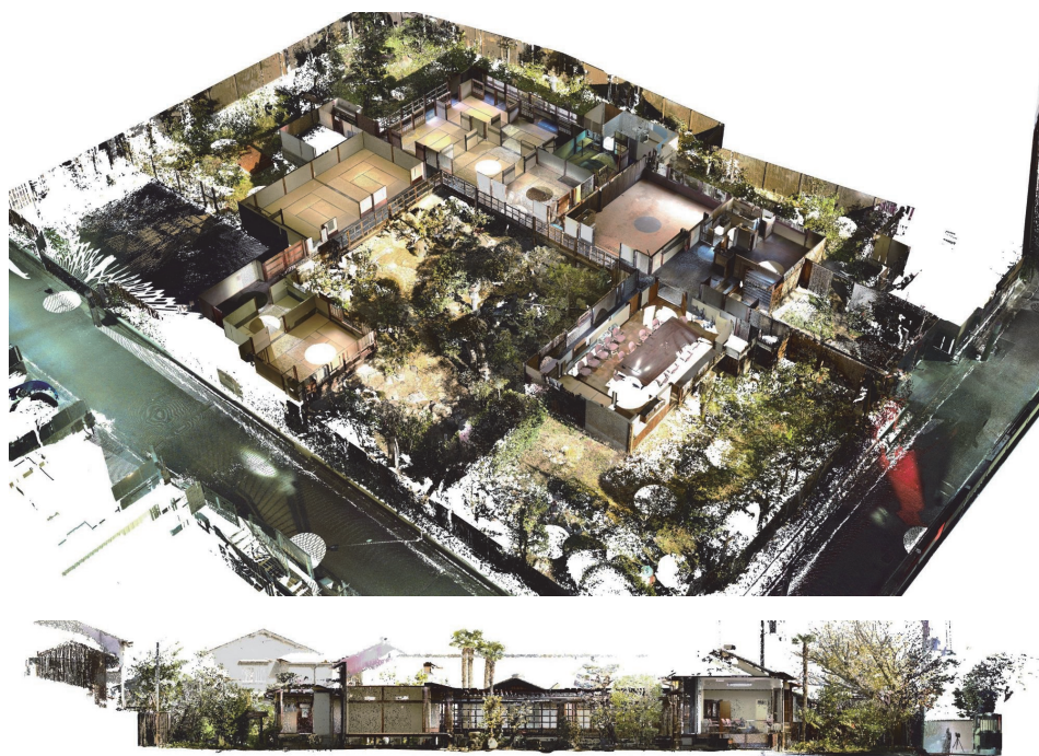
図 白雲荘の点群データと3Dモデリングデータを重ねたアクソメや断面図
