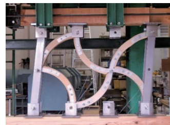
図2 格子壁試験体の加力試験
