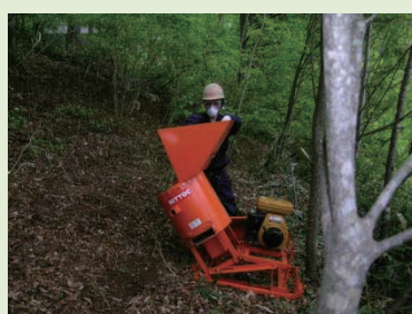
写真-14 ミキサーによる粉砕・改良
