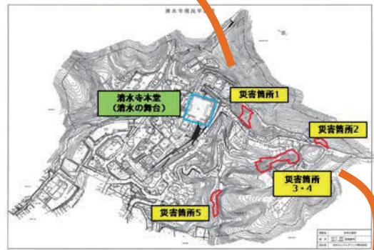
図-1 2013年の斜面崩壊災害発生箇所
