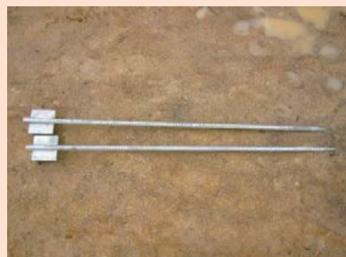
写真-6 プレート付きアンカー
