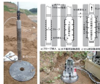
図-3 開発した原位置地盤調査ツール
