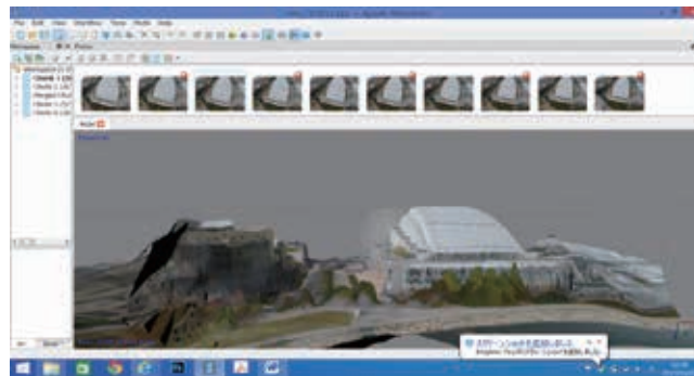
図 6 写真測量による 3 次元景観モデルの構築
