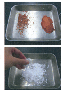
図 12 使用材料 (廃陶器微粉末・細骨材・有機繊維)
