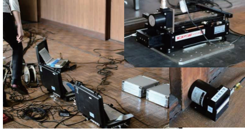
計測状況（起振機・微動計）
