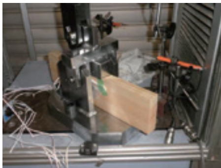
仕口接合部の回転めり込み実験（セル実験室）
