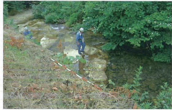
写真2 餅転南の真打川河床の断層露頭、 第三紀層と右側（西側）の河床礫が接触
