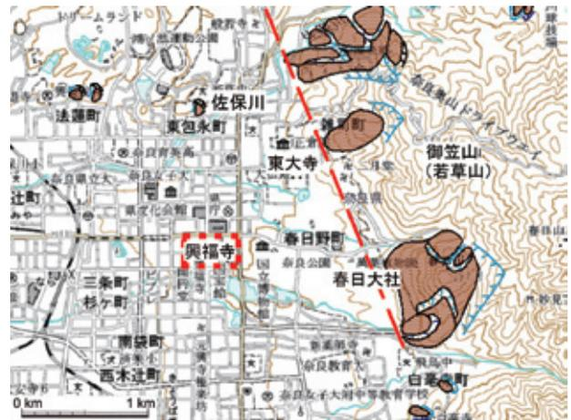
第6図 興福寺 (伽藍の分布域を赤点線の矩形で示す) の位置と周辺の地すべり地形分布。国立防災科学技術研究所地すべり地形分布図「奈良」に加筆。第3図、第5図と同一範囲。
