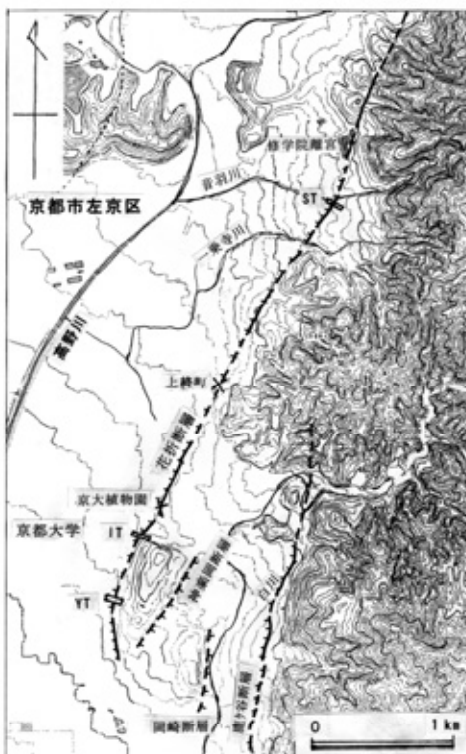
第2図 花折断層南端部付近の地形と活断層配置。等高線は10m間隔。ST: 修学院トレンチ、IT: 今出川トレンチ、YT: 吉田トレンチ。基図は、「1:25,000地形図 京都東北部」
